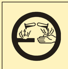
Classe E Matières corrosives
